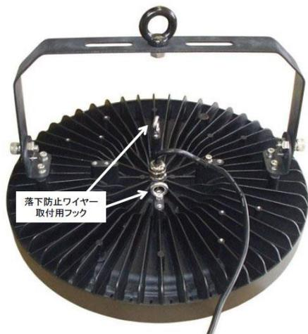
本体背面にある 2 か所の落下防止ワイヤー取付フックに、必ず落下防止ワイヤー(Φ1.5mm 以上のステンレスワイヤー)を取り付けて使用してください。
