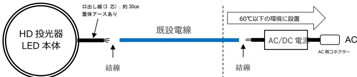
※既設電線の長さによっては、電圧降下により 10%程度照度が下がる場合がございます。
