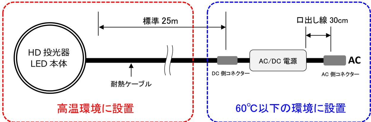
※オプションで 50m または 100m のケーブルをご使用の場合は、下図のように LED 本体と耐熱ケーブルもコネクタで接続されています。コネクタは適宜外して配線工事していただけます。
